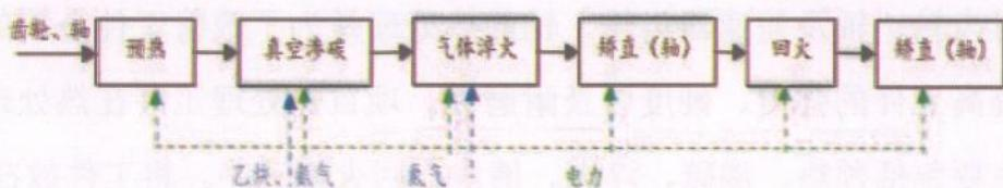
图3.1-6 DL382双离合自动变速器齿轮、轴热处理工艺流程
